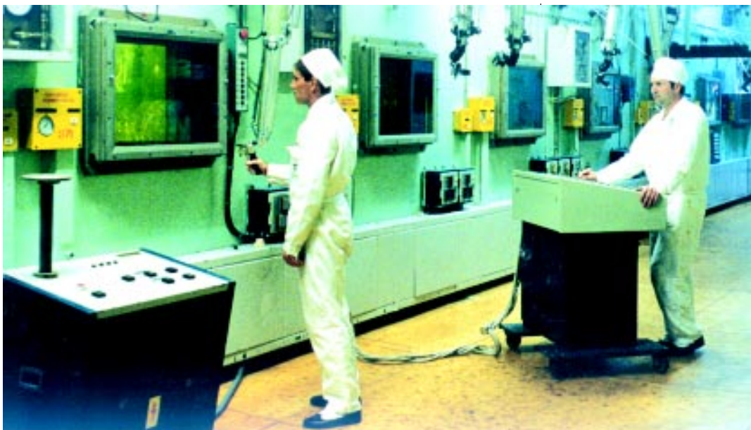
Цепочка защитных камер по изготовлению МОХ-топлива
