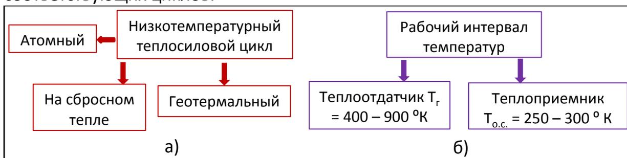
а – варианты теплосилового цикла; б – верхний и нижний рабочие интервалы температур
