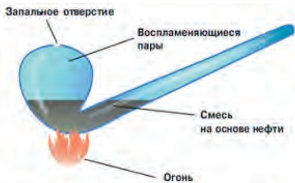
Рис. 2.6 Возможное устройство сифона для метания «греческого огня»
