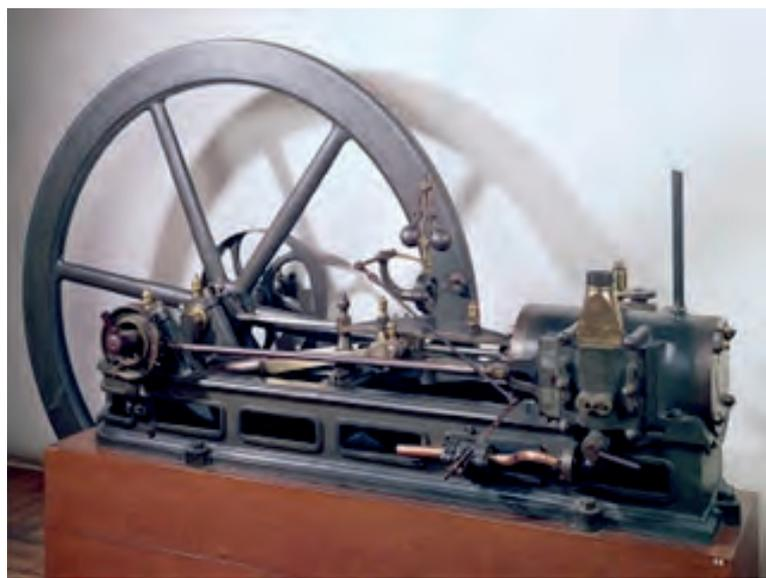
Рис. 3.18 Первый газовый двигатель Ленуара 1860 года
