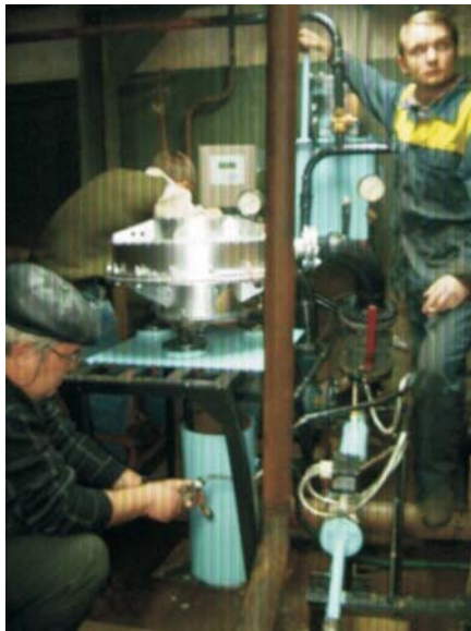
Рис. 5. Замеры теплопроизводительности "БРАВО" специалистами ЗАО "НПО "Тепловизор"
